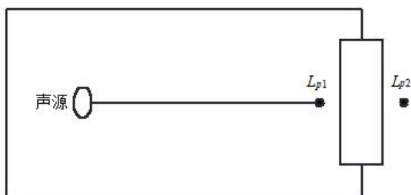
图 4.2.2 室内声源等效为室外声源图例
