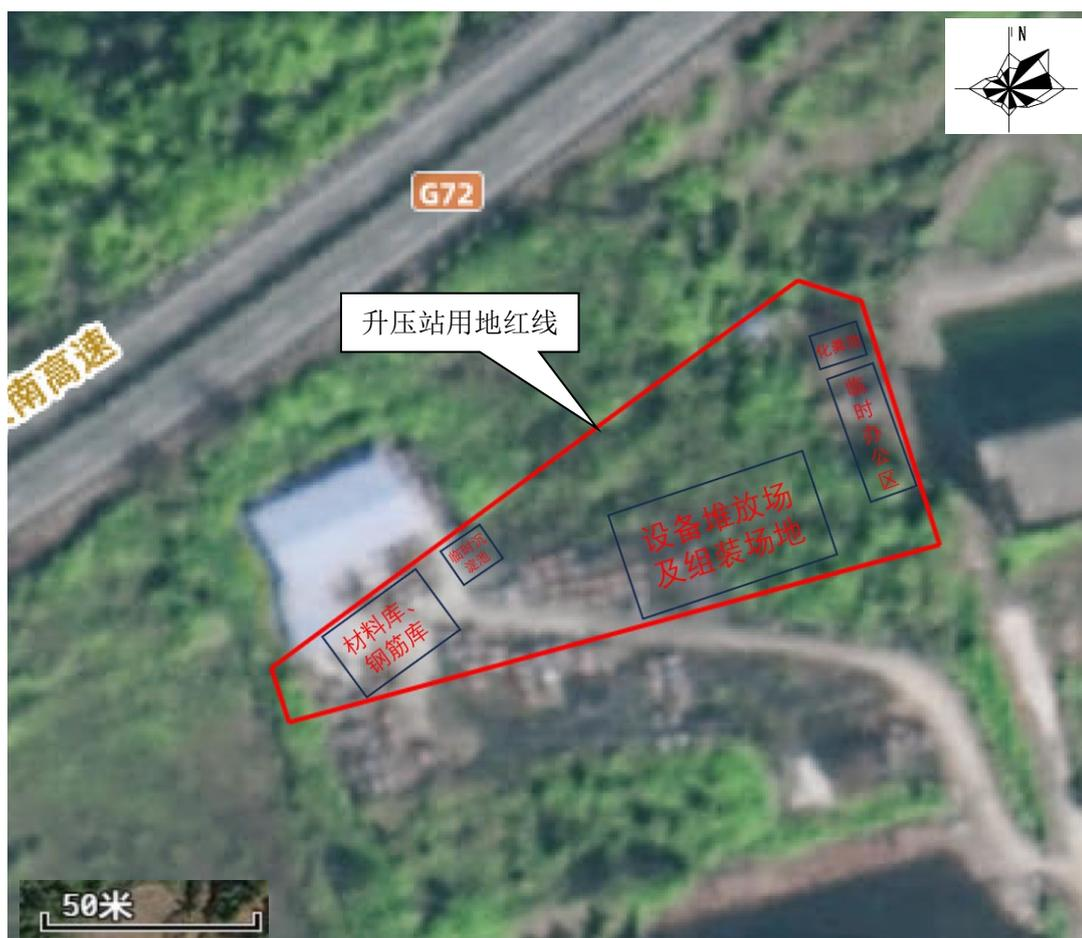
图 2-3 升压站内施工场地平面布置图
