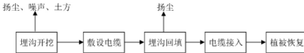
图 2-5 集电线路施工工艺流程及产排污环节图
